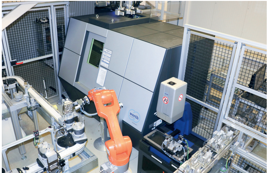
Bild 2. Die automatisierte, in den Fertigungsprozess integrierte Messzelle enthält zwei Koordinatenmessgeräte – eines mit Röntgentomografie (links im Bild) sowie eines mit leistungsstarker Bildverarbeitung (rechts). (© Wert Messtechnik)
